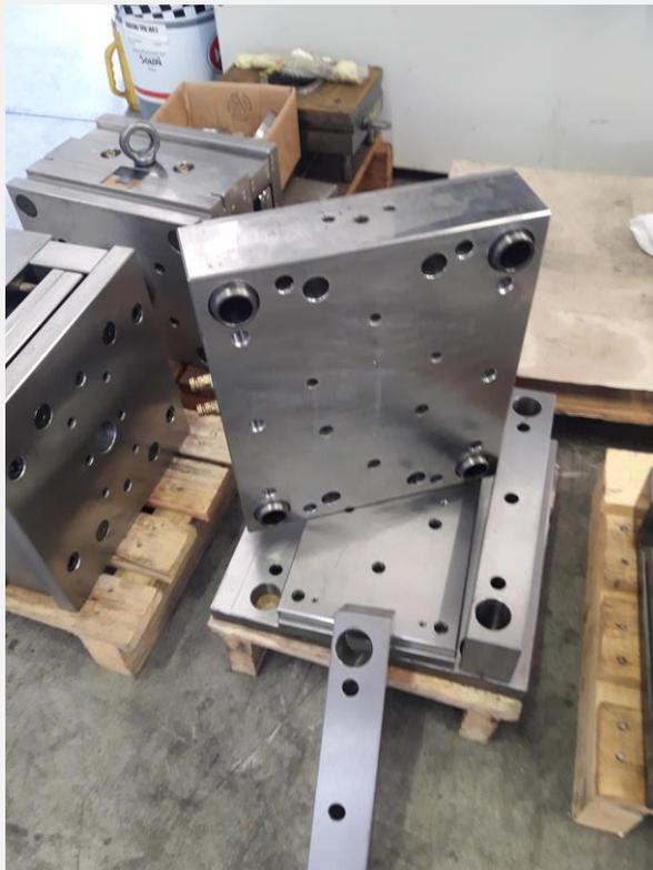
Una volta arrivato dai fornitori il materiale grezzo per realizzare lo stampo occorre passare ad una fase di preparazione, di solito si rettificano le piastre, si controllano ed eventualmente aggiustano le dimensioni dei vari componenti.
